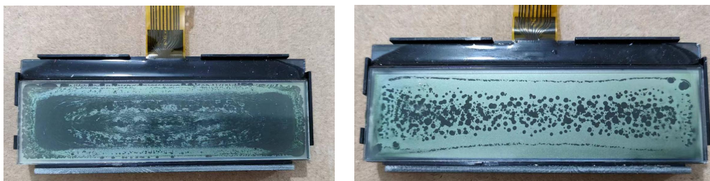
图附 11 经长时间阳光直接照射后，液晶模块无法正常显示。
